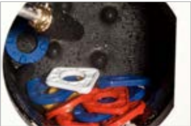
Kunststoffartikulationplatten nach dem Reinigungsprozess (ca. 2 Min.).
