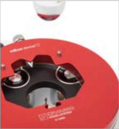
Automatische elektromagnetische Fixierung der DIVARIO® Plattenaufnahme Duo beim Auslösen des Bohrvorganges.
