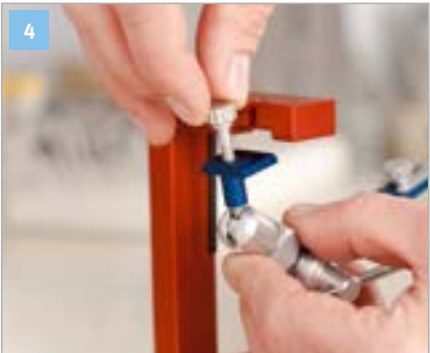
Nach korrekter Positionierung den CORSOFIX® Gelenksupport aus dem ADESSOSPLIT® Übertragungsstand entfernen.
