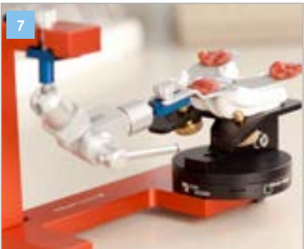
Artikulationsgips inkl. CORSOFIX® Bissgabel abbinden lassen.
