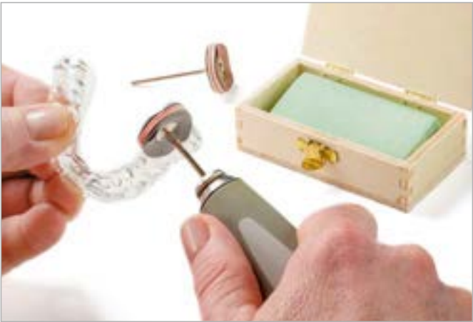
Vor- und Endpolitur einer PMMA Aufbissschiene, mit dem Alcontura Mikrofaserschwabbel weich .
