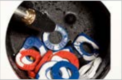
Beispiel 2: Befüllte Trommel mit bis zu 50 Kunststoffartikulationsplatten.
