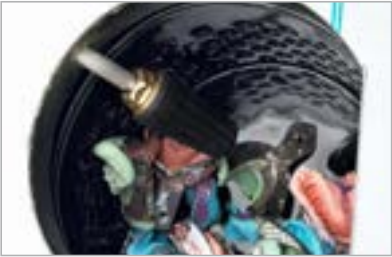
Beispiel 1: Befüllte Trommel mit bis zu 25 Abdrucklöffeln.
