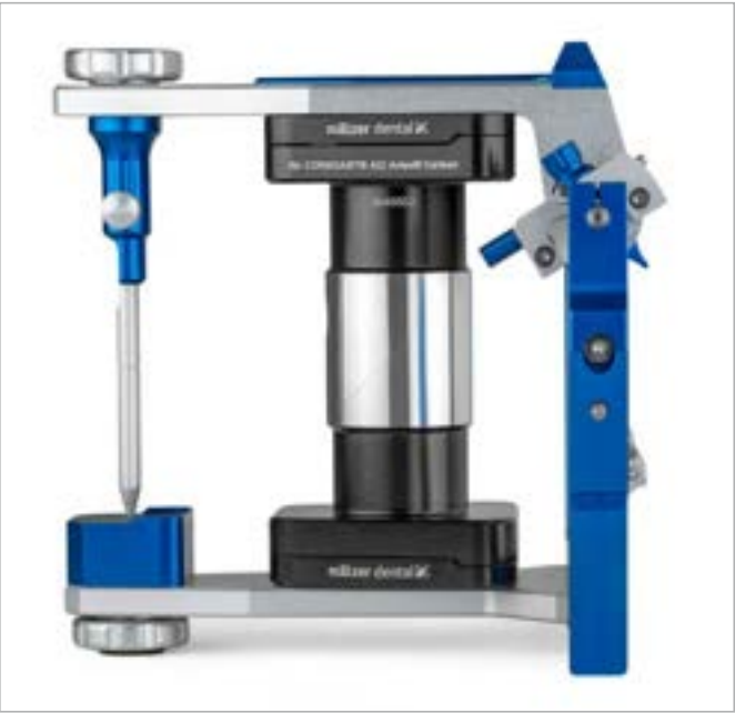
Korrekt justierter Artikulator: spaltfreier Sitz
