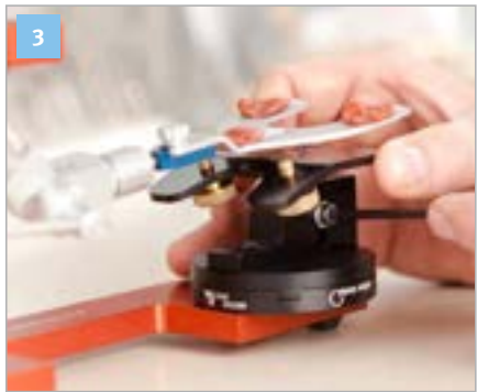
ADESSOSPLIT® Übertragungsstand in Position bringen. Der Abstand zwischen CORSOFIX® Bissgabel und Retentionschrauben soll ca. 5 mm betragen. Der ADESSOSPLIT® Übertragungsstand ist durch Lösen der Inbusschraube in der Höhe verstellbar.
